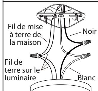
3. Branchez les fils de la mise a terre (cuivre nu ou vert) de votre montage au fil de la mise a terre (cuivre nu ou vert) ou vis de la mise a terre dans la boîte électrique. Posez le fil noir de la fixture au fil noir dans la boîte électrique et posez le fil blanc de la fixture au fil blanc dans la boîte.
