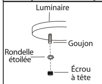
5. Posez le luminaire au plafond en alignant le trou (s) du lustre avec les boulons sur la ferrure de montage. Serrez le luminaire en place à l'aide des écrous étoilés et les écrous à capuchon.
