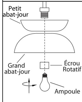
6. Retirez l'écrou rotatif de la douille. Positionnez l'abat-jour sur le luminaire et sécurisez avec l'écrou rotatif.
