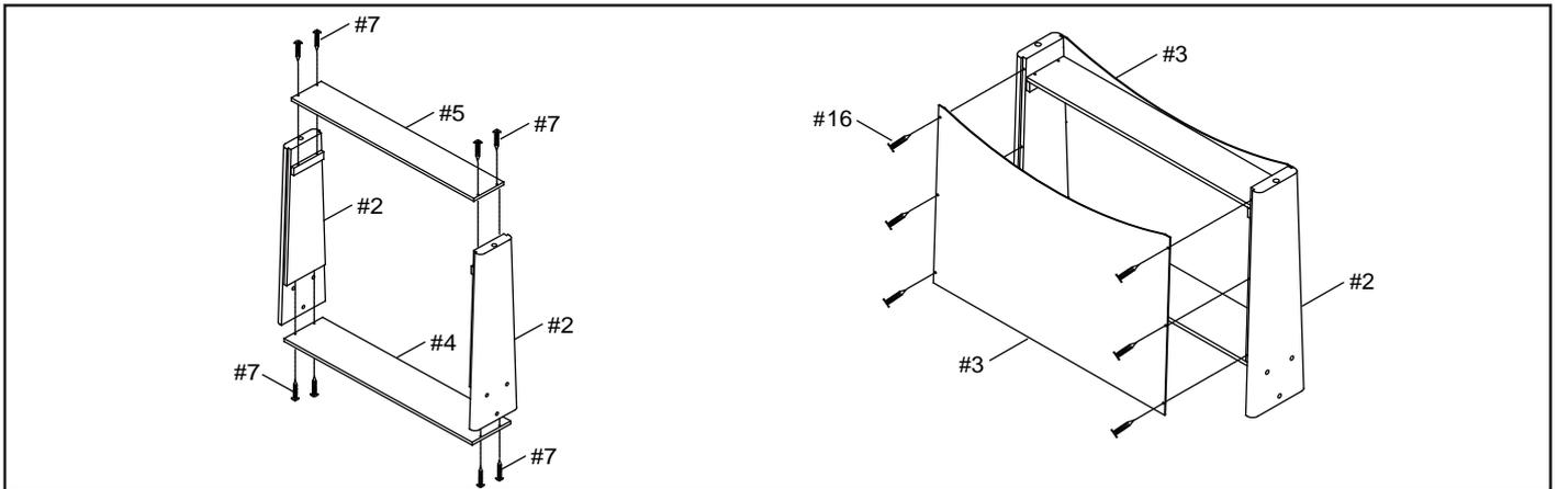
*Remarque: L'assemblage de jambe peut nécessiter deux individus, un pour tenir des morceaux, tandis que l'autre insère des vis. CONSEIL: Si vous insérez toutes les vis, d'une seule pièce, dans les trous pré-perçés avant de serrer, cela aidera à maintenir les pièces en alignement lorsque vous serrez les vis.*
