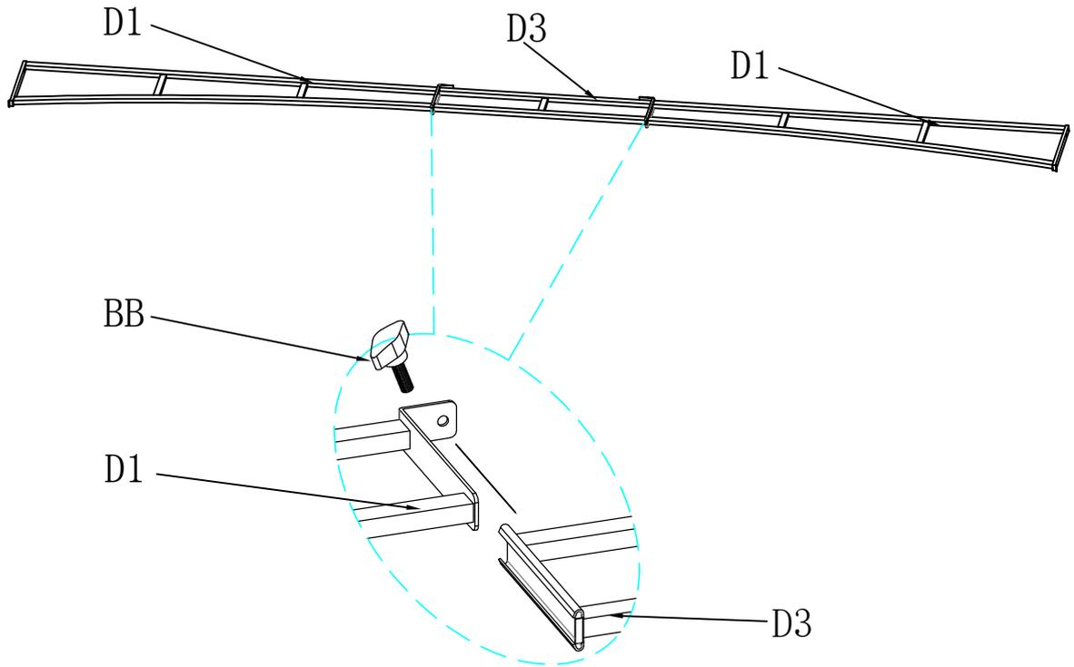
Montez 2 pièces de poutre D1 à chaque extrémité de poutre D3 à l'aide des vis BB.
