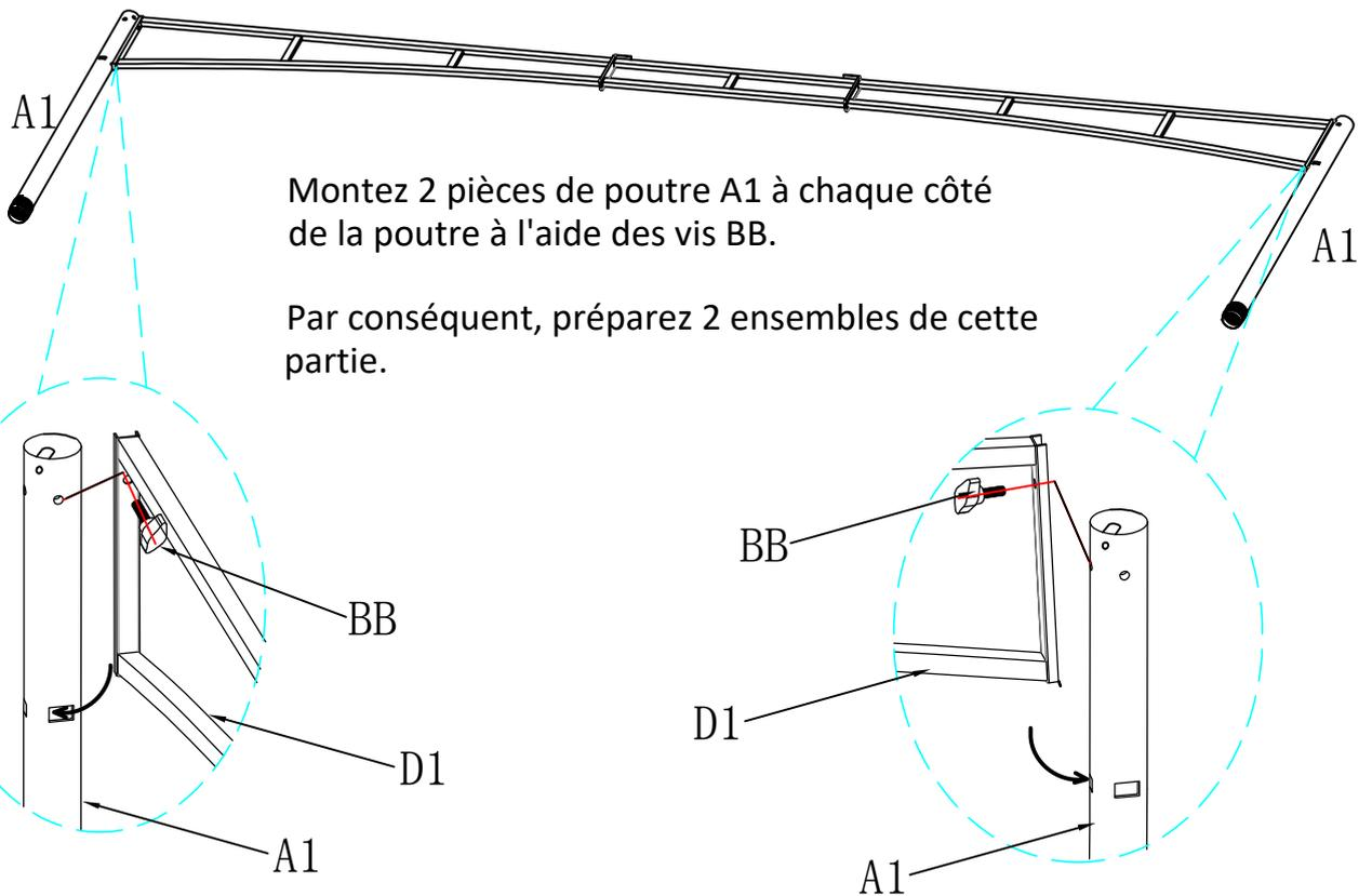
Montez 2 pièces de poutre A1 à chaque côté de la poutre à l'aide des vis BB.
