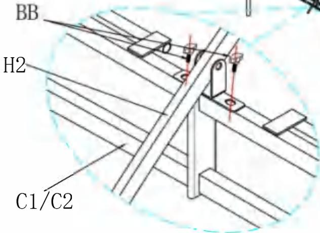
Montez cette pièce avec la poutre (C1/C2) au bout de H2 par les vis BB.
