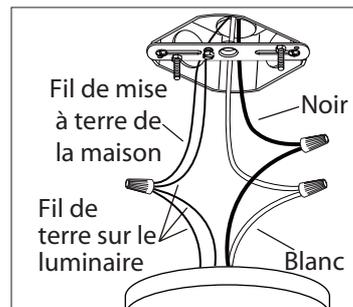
4. Branchez les fils de la mise a terre (cuivre nu ou vert) de votre montage au fil de la mise A terre (cuivre nu ou vert) ou vis de la mise a terre dans la boîte électrique. Posez le fil noir de la fixture au fil noir dans la boîte électrique et posez le fil blanc de la fixture au fil blanc dans la boîte.
