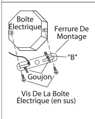
3. Dévissez l'écrou B. Ajustez le poteau à la longueur désirée et barrez en place avec cet écrou. Posez la ferrure d'installation à la boîte de sortie électrique à l'aide des vis de la boîte (en sus). Assurez-vous que les goujons de la ferrure d'installation font face vers l'extérieur de la boîte électrique.
