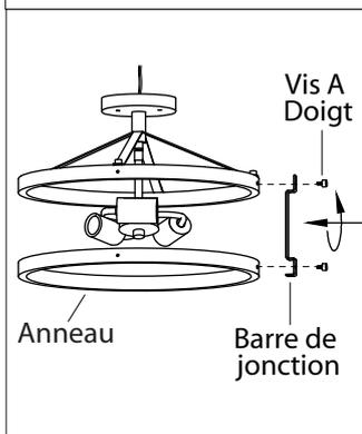
2. Retirez les vis qui se retrouvent déjà sur le luminaire et l'anneau. Installez l'anneau au luminaire à l'aide de la barre de jonction en resserrant les vis.
