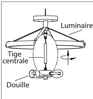
1. Sécurisez la tige centrale et la douille au luminaire.
