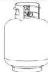
Réservoir de gaz à la verticale pour permettre l'élimination des vapeurs
