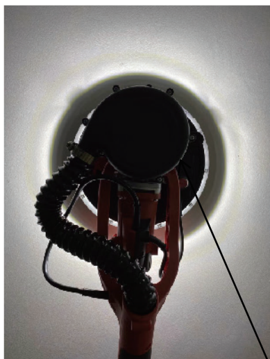
Roue de régulation de l'aspiration
