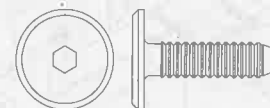
P. M6 x 25mm Bolt X8 boulons M6 x 25mm x8 pernos M6 X 25mm x8
