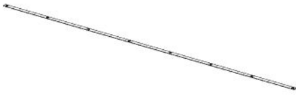
F01 FLAT BAR - A4M02572 (x1) 1/16"x1"x92 13/16" (2x25x2357)
