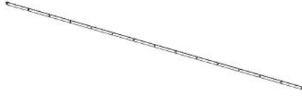
F02 LOUVER TIE STRAP - A4M02573 (x1) 1/8"x13/16"x95 1/16" (3x20x2414)
