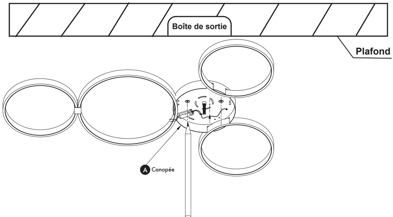
**Retirez le couvercle de l'auvent de l'auvent (A). Soulevez la verrière (A) jusqu'au plafond. Marquer l'emplacement des ancrages en plastique (BE). Trous percés pour les chevilles en plastique (B). Insérez les chevilles en plastique (B) dans le trou.**
