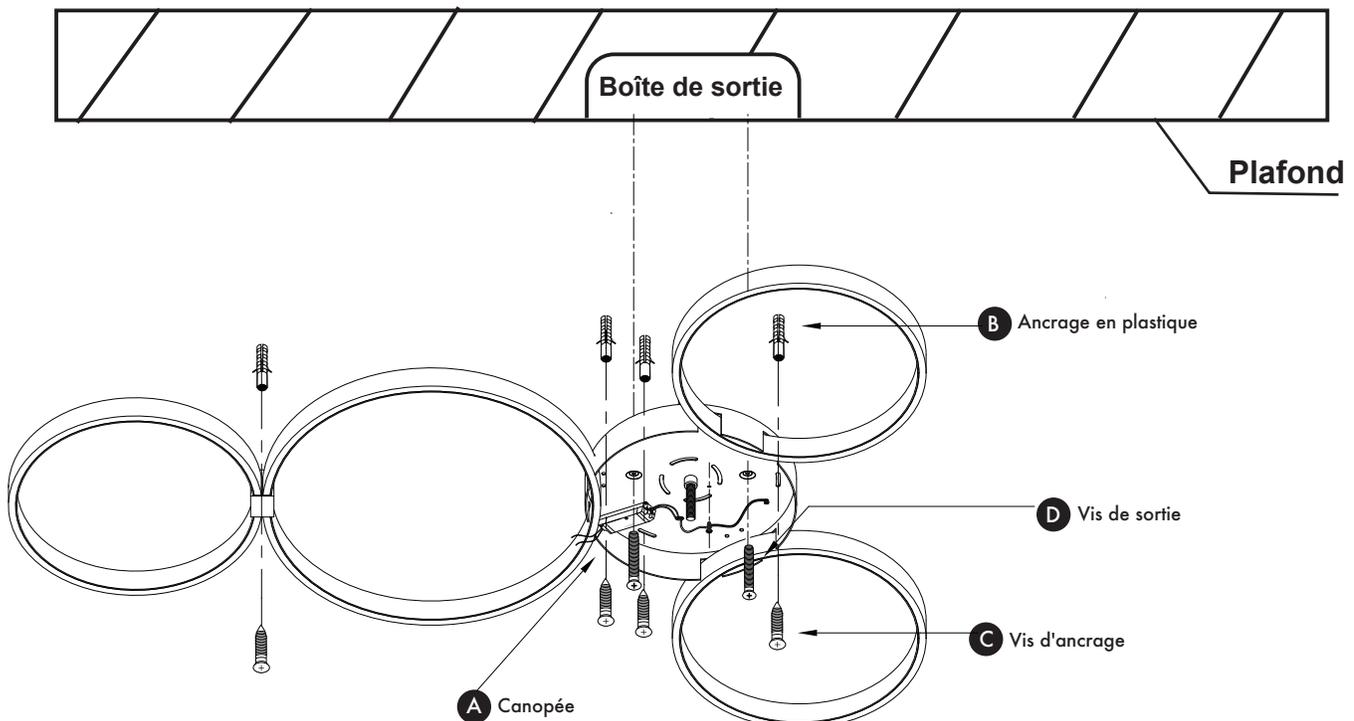
**Fixez l'auvent (A) à la boîte de sortie avec les vis de sortie (D). Vissez les vis d'ancrage (C) dans les ancrages en plastique (B) pour fixer la verrière (A).**
