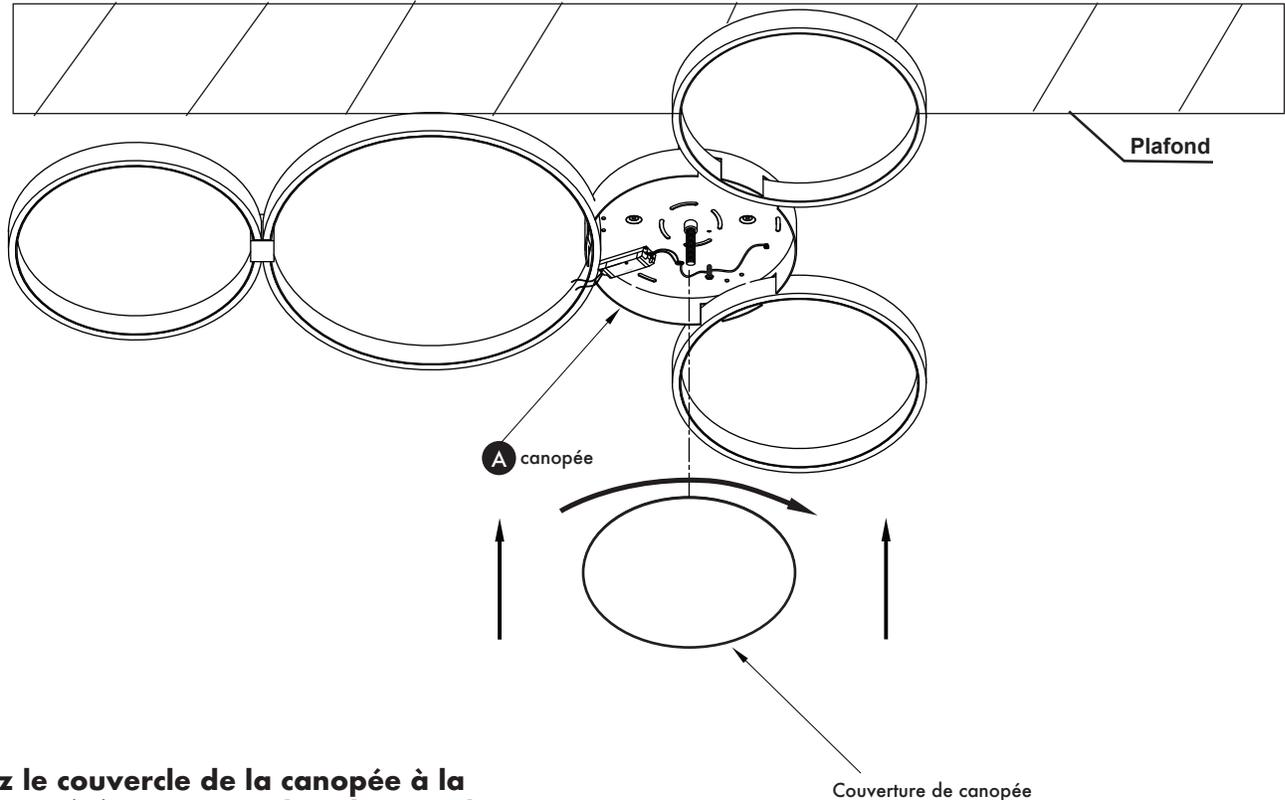
Fixez le couvercle de la canopée à la canopée (A) et tournez dans le sens des aiguilles d'une montre.
