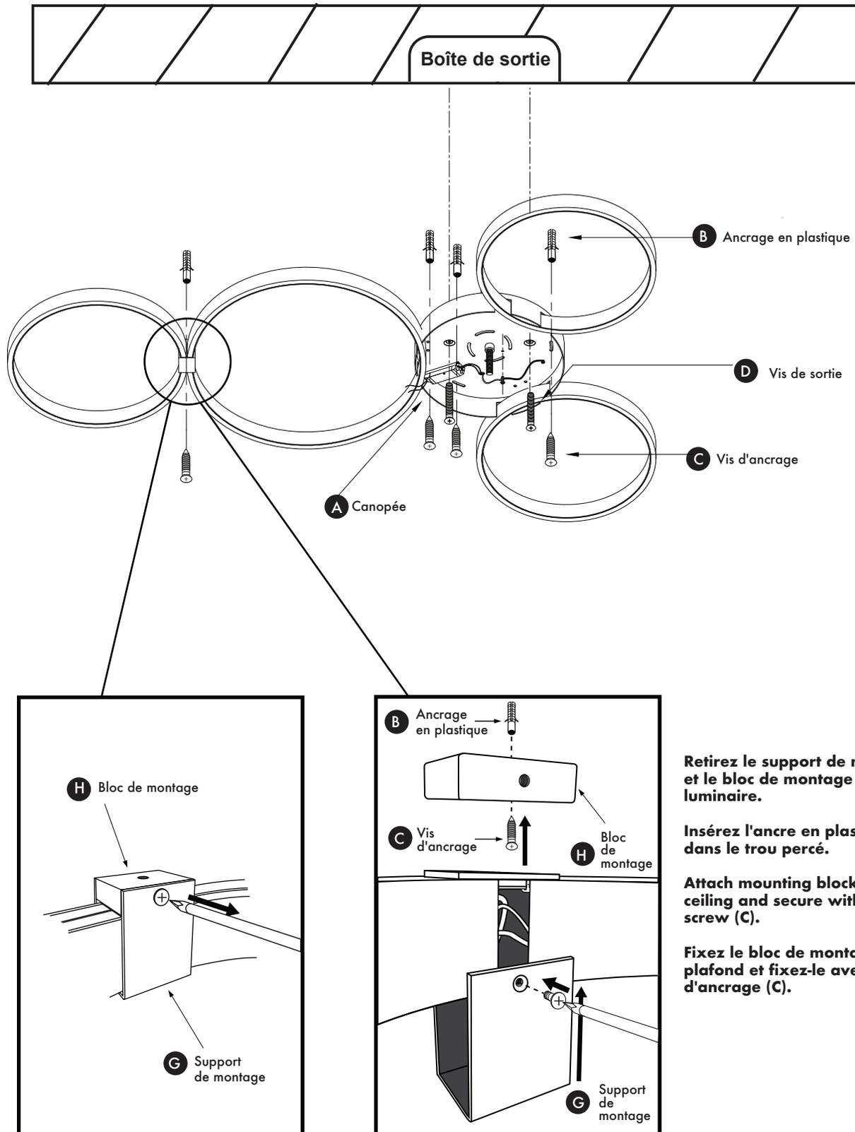
Retirez le support de montage (G) et le bloc de montage (H) du luminaire.
