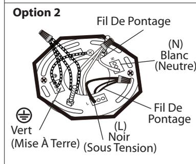
**Option 2:** Lorsqu'il y a des multiples de fils dans la boîte électrique, vert (mise à terre), noir (sous tension), blanc (neutre), poser seulement qu'un de chaque fil soit vert, noir et blanc avant pour la connexion. Retirez 7mm de la gaine d'un fil de pontage de 6" (AWG 12-24) inclus. Posez (poussez) les fils dans les insertions appropriées.
