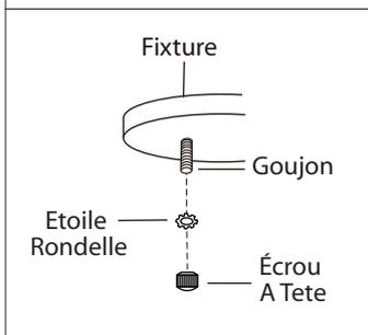
5. Poussez délicatement les fils à l'intérieur de la boîte électrique et placez le luminaire sur les goujons sur la ferrure de montage. Serrez le luminaire en place à l'aide des écrous étoilés et les écrous à capuchon.
