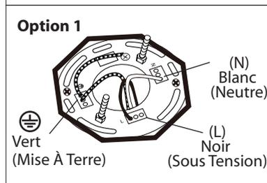
3. **Option 1:** Poussez pour brancher les fils de la boîte électrique (courant de la maison) dans les insertions appropriées. Noir (sous tension), blanc (neutre), vert (mise à terre)
