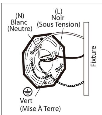
4. Branchez (poussez) les fils électriques du luminaire dans les insertions appropriées.
