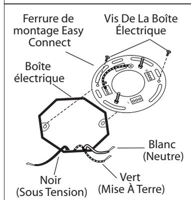
2. Posez la ferrure de montage easy connect à la boîte électrique à l'aide des vis de la boîte électrique (en sus).
