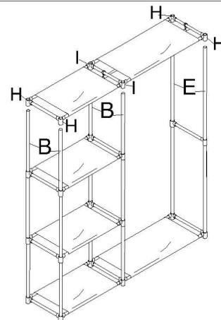
Befestigen Sie die Rahmen H,I von Schritt 5 an Teilen B, E.
