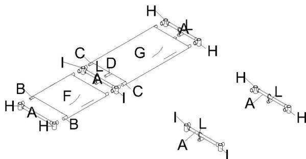
Wiederholen Sie einmal Schritt 1 für den Grundboden, aber bitte setzen Sie zuerst vor Zusammenbau Teil L in Teil A ein, schließlich Teil D in Teil L.
