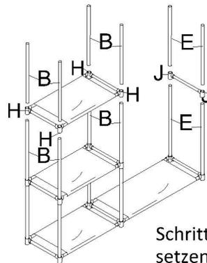
Wiederholen Sie einmal Schritt 3 für die linke Seite, dann setzen Sie rechterseits Teile E in Teile J ein.
