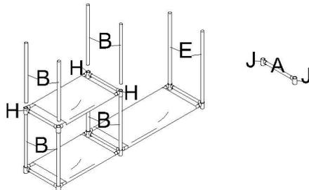
Befestigen Sie den kleine Zwischenboden von Schritt 1 an Teilen B, und Setzen Sie Teile B in Teil H auf den linken Regal ein, dann bauen Sie Teil A,E mit Teil J auf den rechten Regal zusammen.
