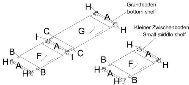
Befestigen Sie Teil F an Teilen B, Teil G an Teilen C, dann bauen Sie Teile A&B&C mit Teilen H&I zusammen.
