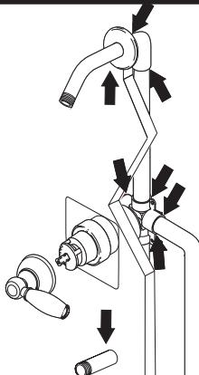
**FLUSH SYSTEM / CHECK FOR LEAKS.**
