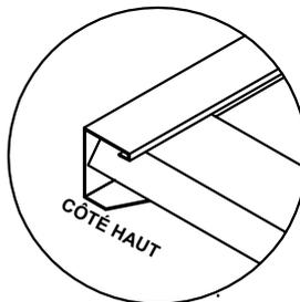
Chaque profilé en U doit être bien aligné par rapport aux tôles. Le système Snap Tite permet d'ajuster la position du profilé. Il suffit de taper dessus pour qu'il glisse et soit parfaitement aligné par rapport aux extrémités de la tôle.
