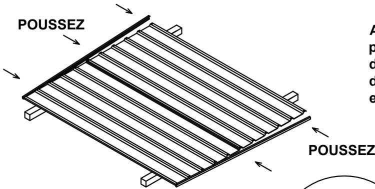
Après avoir assemblé les tôles, placez le profilé en U à une extrémité des tôles, puis tapez doucement dessus afin de l'enclencher, de part et d'autre de la tôle.
