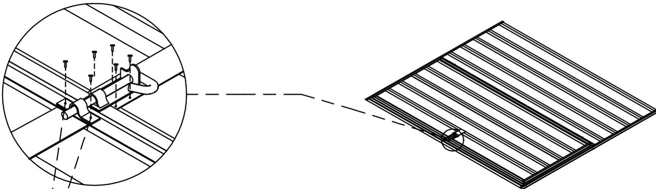
REMARQUE : les deux trous nécessaires à la fixation du morillon du loquet pour chacune des portes n'ont pas été préperforés pour que vous puissiez les aligner correctement. Placez les morillons au centre par rapport à la tige du loquet, percez des trous de 3 mm et fixez-les à l'aide de vis.
