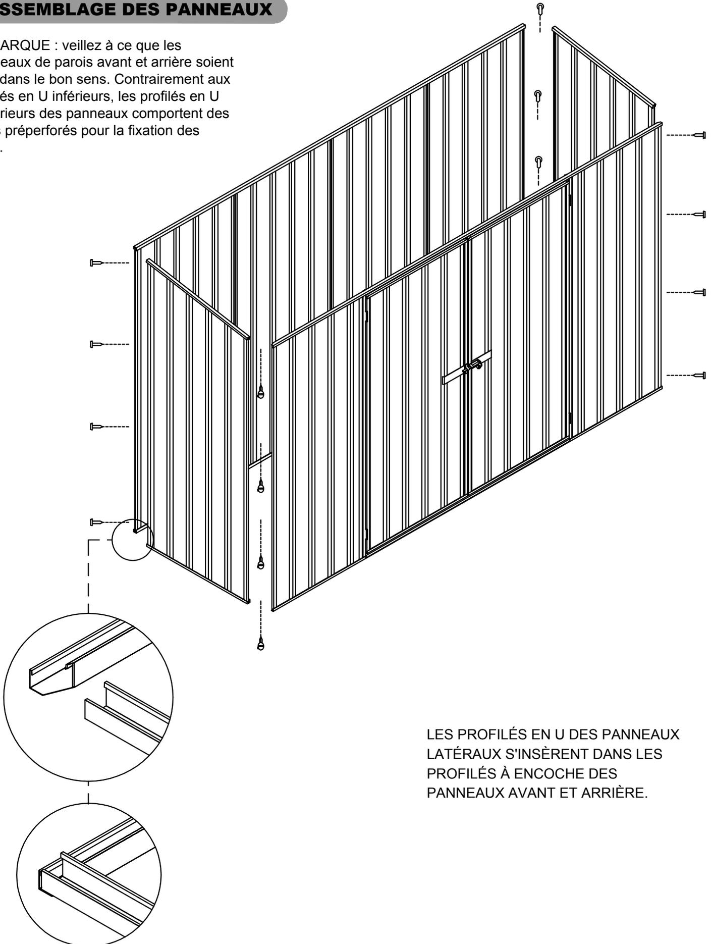
LES PROFILÉS EN U DES PANNEAUX LATÉRAUX S'INSÈRENT DANS LES PROFILÉS À ENCOCHE DES PANNEAUX AVANT ET ARRIÈRE.
