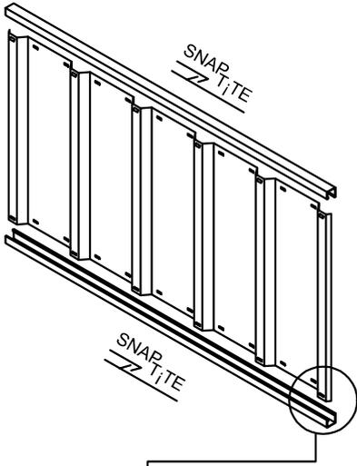
Afin de préassembler les quatre panneaux de paroi et les deux panneaux de toiture, les profilés en U s'enclenchent en haut et en bas de chacun des panneaux à l'aide du système Snap Tite, tel qu'illustré sur les pages suivantes lorsque vous verrez le symbole:
