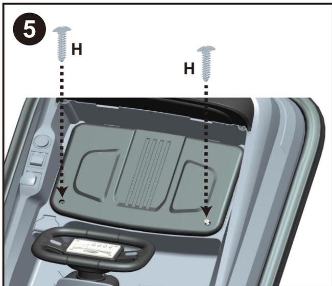
“Encliqueter ” le siège au bon endroit et le fixer à l'aide de deux vis (4 x 16 mm) comme indiqué sur l'image.
