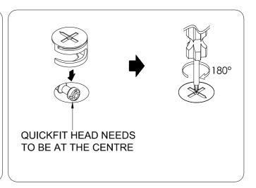
QUICKFIT TIGHTEN UNTIL SHOULDER IS FLUSH WITH PANEL. DO NOT OVER TIGHTENED OR UNENLIGHTENED (SEE EXAMPLE BELOW)
