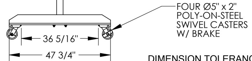
FOUR Ø5" x 2" POLY-ON-STEEL SWIVEL CASTERS W/ BRAKE
