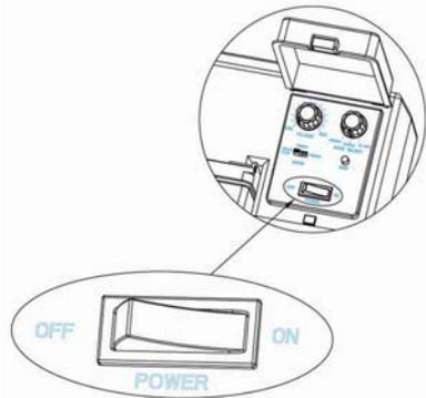
**FIG III: POWER SWITCH**
