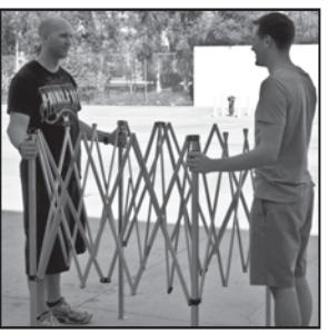
Placez l'armature de l'abri au centre de l'espace de montage. Avec l'aide d'une autre personne placée sur le côté opposé de l'armature, tenez les deux pattes extérieures et soulevez-les légèrement au-dessus du sol. Faites quelques pas vers l'arrière jusqu'à ce que l'armature soit ouverte à bout de bras, soit sur environ 1,20 m/4 pi (figure A).
