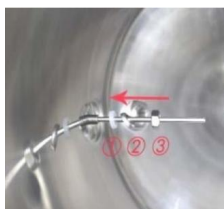
Monteer de onderdelen in de juiste volgorde. (Siliconenring + platte sluitring + moer)
