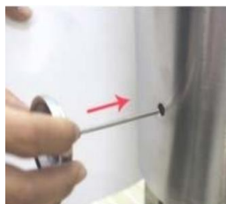
Steek de thermometer in het gat
