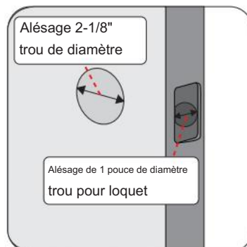
Mesurer le diamètre du 2 trous
