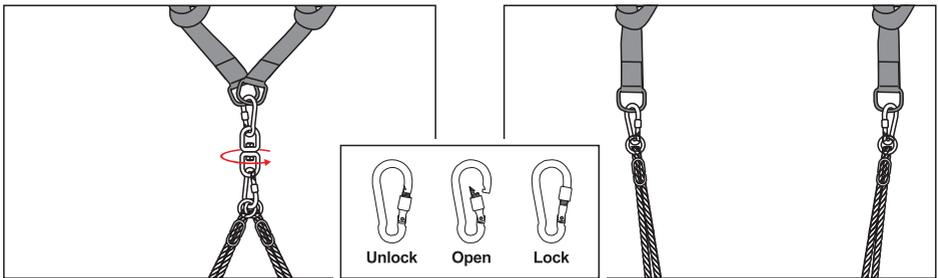
Abbildung 3: Stellen Sie das Seil auf die gewünschte Länge ein und halten Sie das Gleichgewicht.
