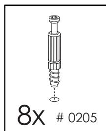
Installez les 8 boulons vissables # 0205 dans les moulures AA, BB et F
