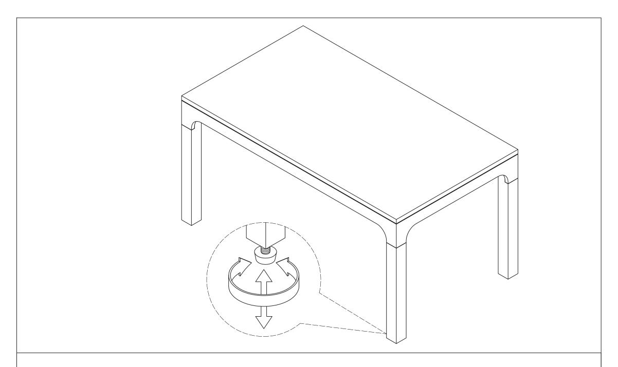
STEP 3 ADJUST THE ADJUSTER THAT HAS ALREADY BEEN ASSEMBLED TO THE LEGS TO STABILIZE YOUR UNIT.
