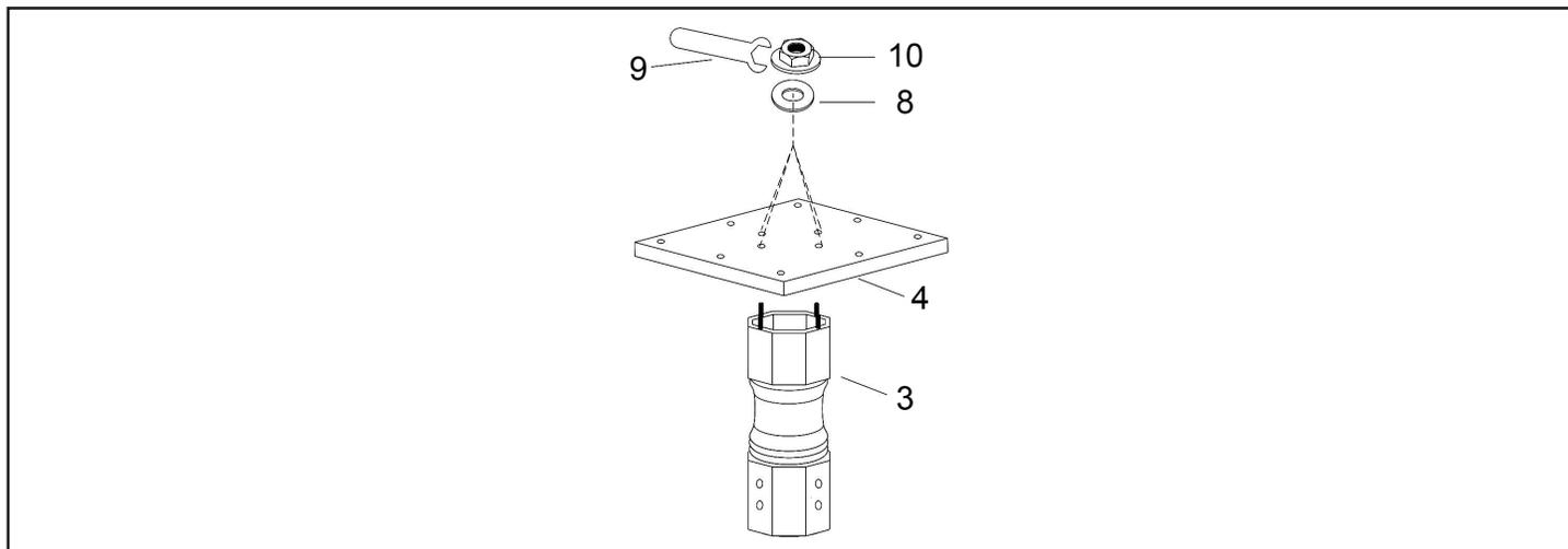
2. Fixez le PIÉDESTAL assemblé sous la STRUCTURE PRINCIPALE (no 1) à l'aide d'ÉCROUS et de RONDELLES PLATES (no 8).
