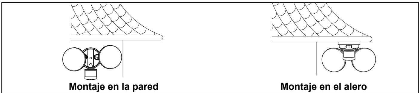
Lea la sección de notas en la página 4 para obtener información adicional sobre la ubicación de montaje del artefacto. El artefacto de luz y el sensor deben montarse como se muestra arriba cuando se instalen (dependiendo del tipo de instalación). Antes de instalar el artefacto de iluminación debajo de un alero, el cabezal sensor debe girarse como se muestra en los siguientes dos pasos para obtener un funcionamiento adecuado y para evitar el riesgo de choque eléctrico.
