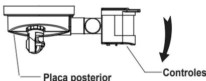
☉ Gire el cabezal sensor 180° hacia la derecha para que los controles queden orientados hacia abajo.
