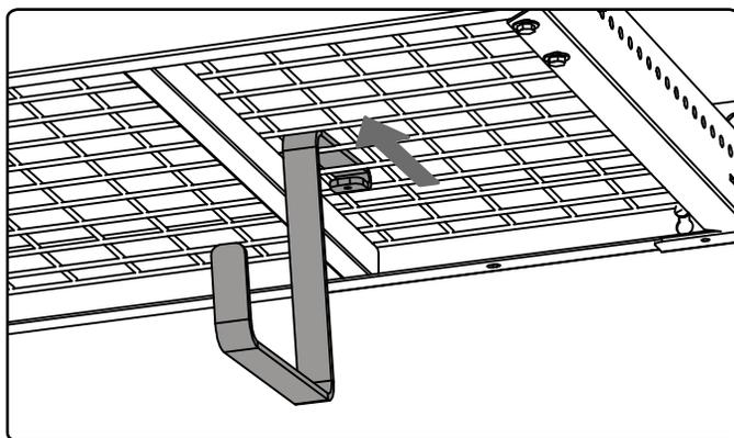
**3** Vissez le boulon 5/16 po dia x 1/2 po pour fixer le crochet utilitaire et serrez-le à l'aide d'une clé.
