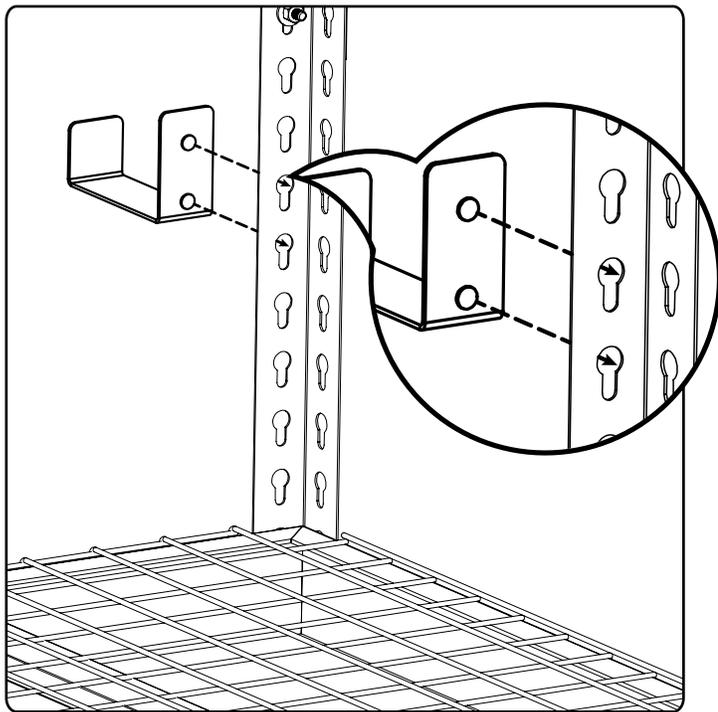
**2** Faites glisser le J - crochet vers le bas pour aligner les bossages de rivet avec le fond des trous .
