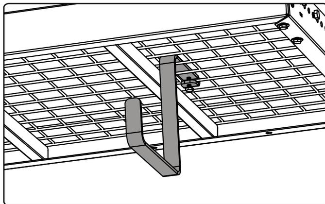
**1** À partir du bas de l'étagère murale Pro, déterminez l'emplacement du crochet utilitaire à installer; faites glisser l'extrémité repliée avec les trous de boulon du crochet en S vers le haut à travers l'ouverture dans le grillage.
