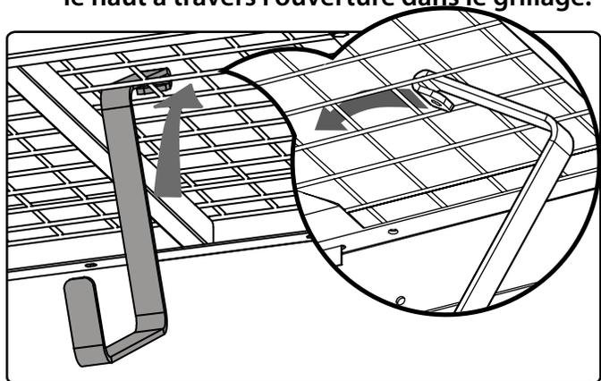
**2** Faites glisser l'extrémité repliée avec les trous de boulons du crochet en S sur le grillage.
