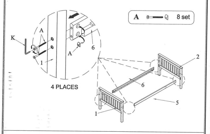
STEP 2: LONG GUARDRAIL - SHORT GUARDRAIL ASSEMBLY
