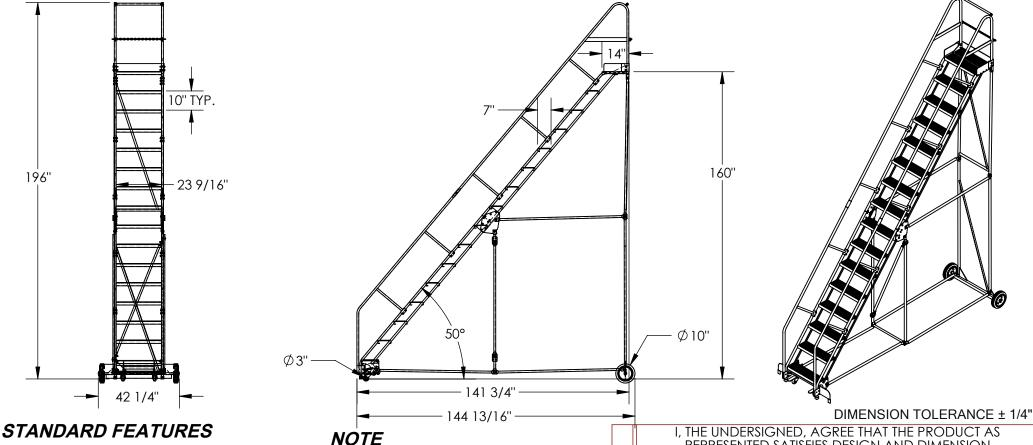
MODEL NUMBER IS LAD-16-14-P-EZ OVERALL WIDTH IS 42 1/4" **USABLE WIDTH IS 23 9/16" OVERALL LENGTH IS 144 13/16" USABLE LENGTH IS 141 3/4" OVERALL HEIGHT IS 196" TOP STEP HEIGHT IS 160"** STEP TYPE IS PERFORATED CLIMB ANGLE IS 50° STEP DEPTH IS 7" **TOP STEP DEPTH IS 14"** MAX CAPACITY IS 350 LBS WHEEL SIZE IS Ø10" FRONT WHEEL SIZE IS Ø 3" TOUGH BAKED IN POWDER COATED BLUE FINISH BOTTOM STEP HAS TOUGH BAKED IN POWDER COATED YELLOW FINISH
