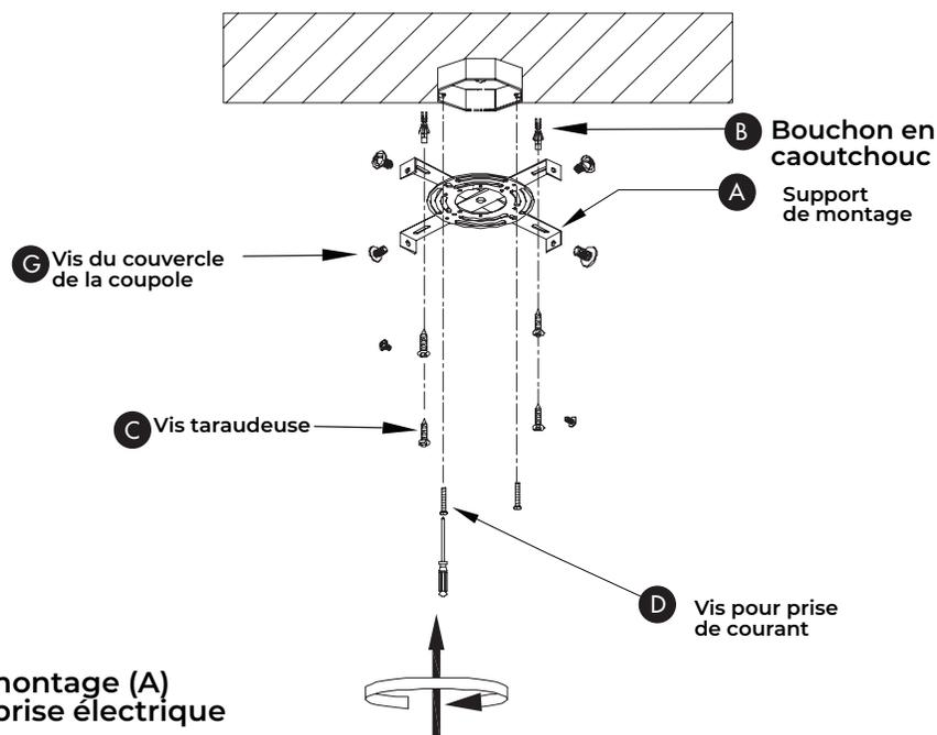
Fixez le support de montage (A) à l'aide des vis pour prise électrique (B), (C), (D).
