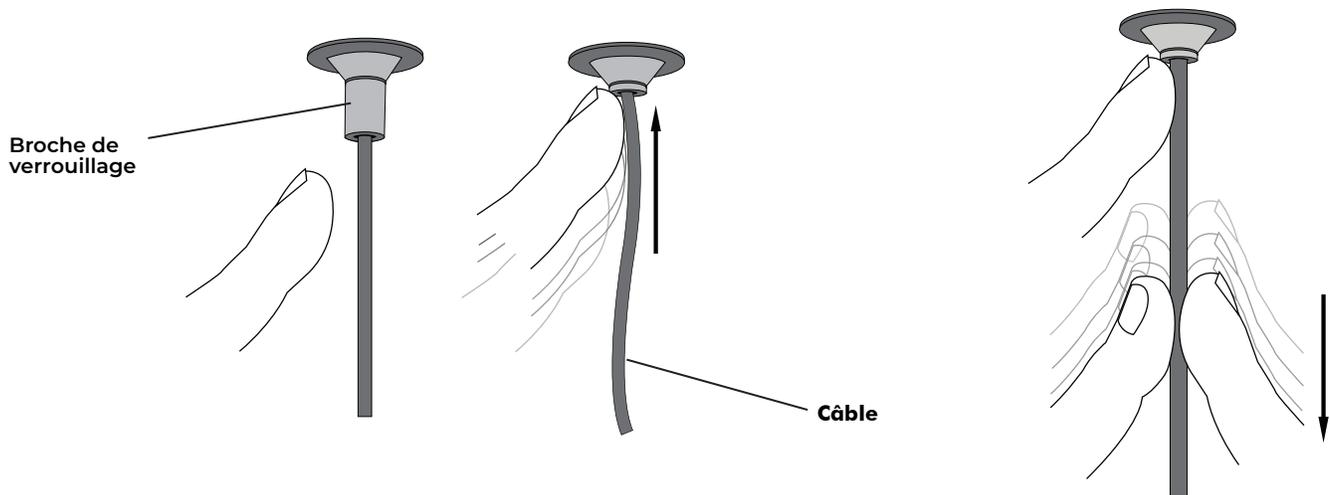
La longueur du câble est réglable. Pour régler le câble à la longueur souhaitée pour le luminaire, maintenez la coupole du luminaire contre le boîtier de prise électrique dans le plafond.
