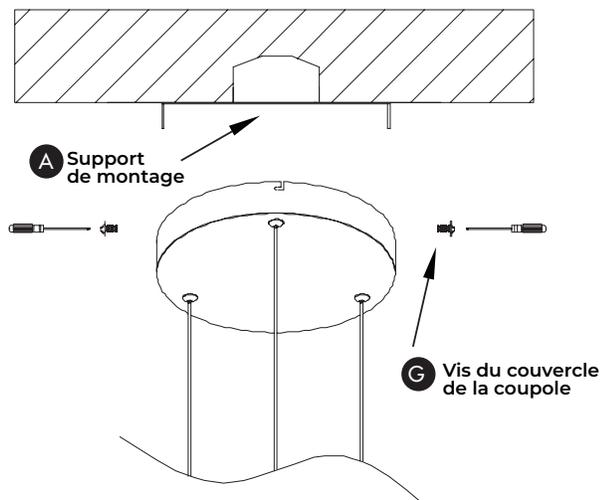
Fixez la coupole au support de montage (A) à l'aide des vis du couvercle de la coupole (G).
