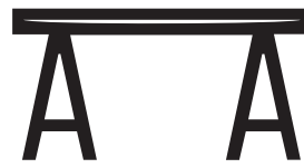
Surface de travail surélevée. Chevalets et bois de sciage
