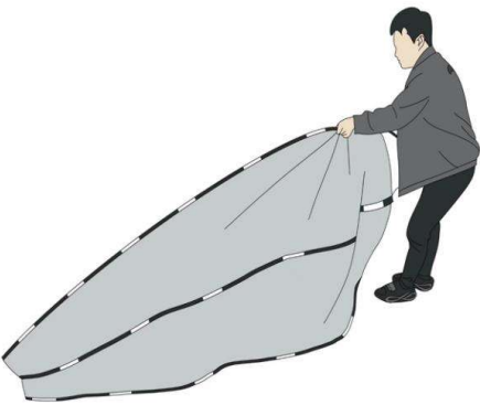
1.各ロッドをテントチューブに挿入します
