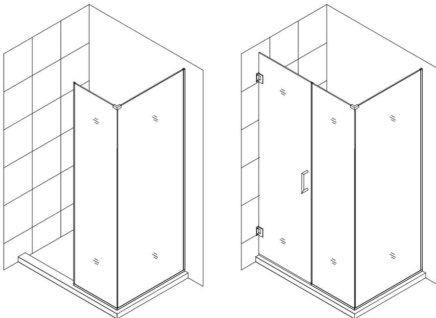
*Illustration d'un panneau installé du côté droit*
