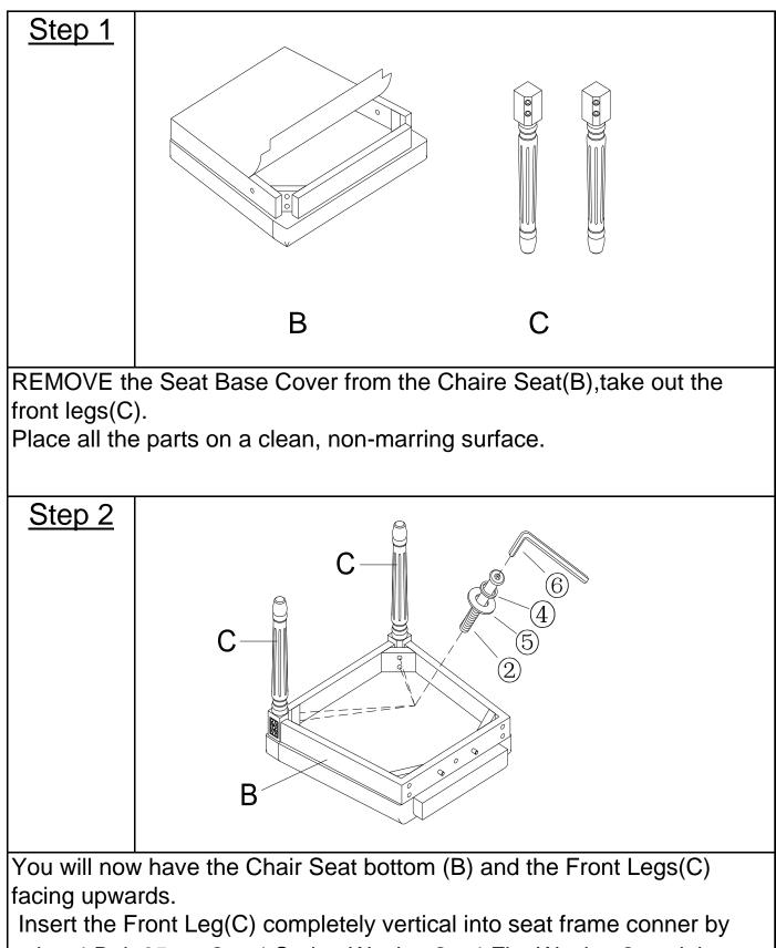
using 4 Bolt 65mm<sup>2</sup> + 4 Spring Washer<sup>4</sup> + 4 Flat Washer<sup>5</sup> and the Allen Wrench<sup>6</sup>.
