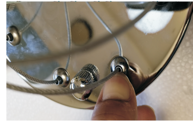
6、钢丝线要拉长时，用指甲往里按住拉力头突出的部位，然后把钢丝线往外拉出即可。
