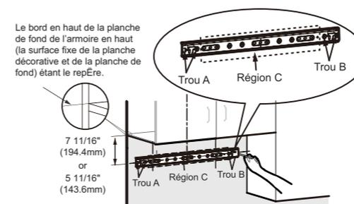
**Attention:** Au moins une des vis de bois (#10x2 9/16" (ST5x65mm)) du crochet de l'appareil principal doit être fixée sur la poutre en bois. Il faut mettre les vis de fixation dans les trous A et B illustrés dans la figure. La partie de la position du trou de crochet dans la zone C, qui est correspondante au pieu, doit être équipée des vis de bois (#10x2 9/16" (ST5x65mm)) de fixation.
