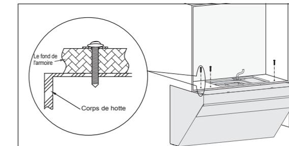
S'il existe une fente relativement grosse entre le fond de l'armoire et l'appareil principal, veuillez ajouter un morceau de bois près des 3 vis de dimension #10×2 13/16" (M5×70mm) selon la taille de la fente avant l'installation de l'appareil afin d'éviter la déformation de l'appareil durant la fixation des vis.
