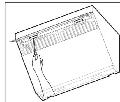
4. Démontez le câble de la lampe et remplacez toute la lampe LED.
