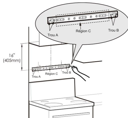
**Attention:** Il faut mettre les vis de fixation dans les trous A et B illustrés dans la figure. La partie de la position du trou de crochet dans la zone C, qui est correspondante au pieu, doit être équipée des vis de bois (#10×2 9/16" (ST5×65mm)) de fixation.
