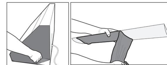
7. Soulevez l'appareil principal. Accrochez d'abord la machine sur l'accroche en l'inclinant, à l'aide du trou qui se trouve sur le bas de l'arrière de l'appareil. Poussez ensuite la hotte contre le mur.
