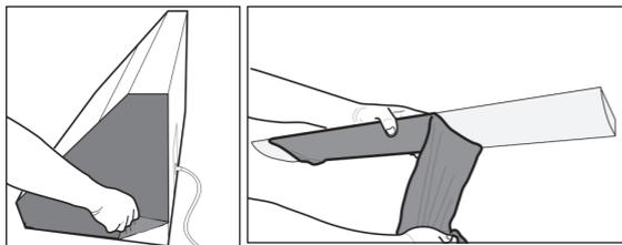
7. Soulevez l'appareil principal. Accrochez d'abord la machine sur l'accroche grâce au trou qui se trouve sur le haut de l'arrière de l'appareil. Stabilisez la hotte et vérifiez son horizontalité à l'aide d'un niveau à bulle. Fixez ensuite les bouchons de sécurité au-dessus de la hotte (Le cran de sûreté se trouve dans le paquet d'accessoires qui se trouve lui-même dans la boîte d'emballage des pièces composantes de l'enveloppe décorative.).
