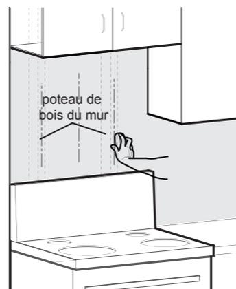
3. Déterminez l'emplacement de l'accroche de fixation de l'appareil principal : identifiez le centre d'installation de la hotte, puis tracez une ligne médiane verticale. Déterminez l'emplacement
