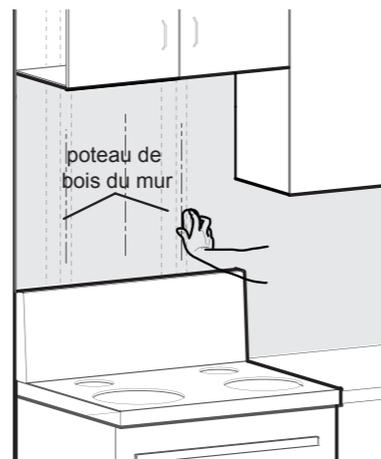
3. Déterminez l'emplacement de l'accroche de fixation de l'appareil principal : identifiez le centre d'installation de la hotte, puis tracez une ligne médiane verticale. Déterminez l'emplacement de l'accroche avec comme référence le point le plus bas du fond de l'armoire du dessus. Marquez ensuite les emplacements de perçage. La distance entre le point le plus bas du fond de l'armoire et le centre du crochet est 16" (405mm).
