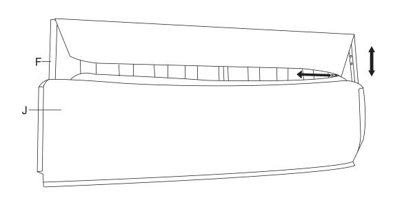
6. ZIP IN TO ASSEMBLE THE BACKREST FRAME(F) AND FABRIC COVER(J). MAKE SURE THE FRAME'S ROUND CORNERS ARE AT UP SIDE AND THE SCREW HOLES ARE AT DOWN SIDE.
