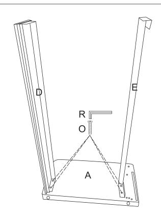
1. SCREW IN THE BOLTS(OX4PCS) TO ASSEMBLE ARMREST RIGHT-HAND SIDE(A) / SEAT FRONT PANEL(D) AND SEAT BACK CONNECTION BAR(E). TIGHTEN ALL BOLTS TO 100%.
