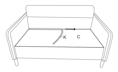
11. ATTACH THE FABRIC STRIP ONTO BACKREST COVER(J) AND SEAT PAD(C) BY USING THE VELCRO.
