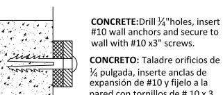
**CONCRETO:** Taladre orificios de  $\frac{1}{4}$  pulgada, inserte anclas de expansión de #10 y fijelo a la pared con tornillos de # 10 x 3 pulgadas.
