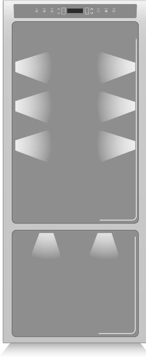
Afin de permettre une vision interne optimale est prévue un système à LED qui illumine directement différentes zones du compartiment Réfrigérateur, des bacs Fresco-Fresco et du bac Congélateur. Sur certains modèles, est également prévu un système d'éclairage externe situé à la base de l'appareil.
