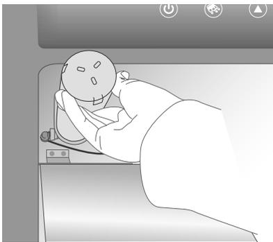
Le filtre est situé derrière le verre rodé dans la partie supérieure du réfrigérateur.
