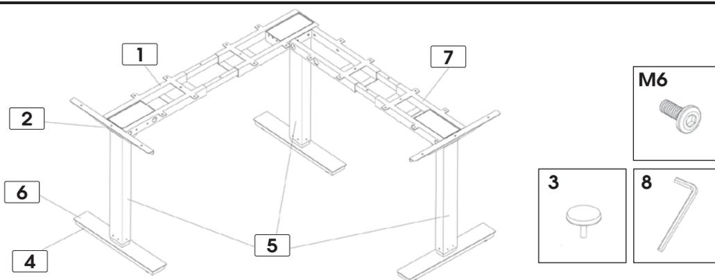
**1** Dévissez les 8 vis sous la structure pour permettre l'ajustement de la longueur.
