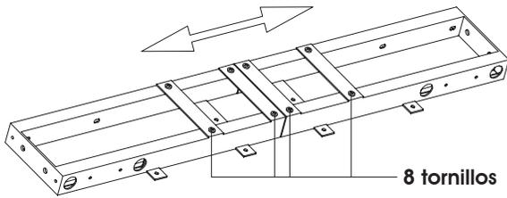
**2** Fije las patas ajustables con los tornillos M6 como se muestra.
