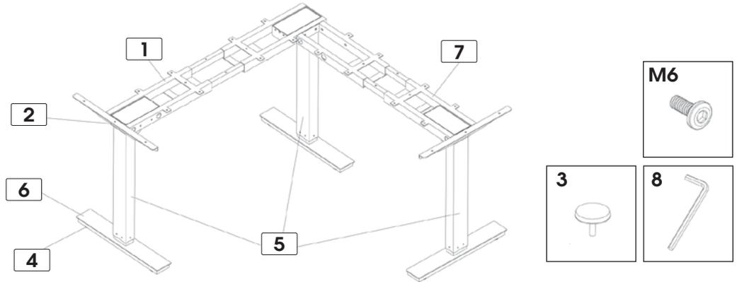
**1** Afloje los 8 tornillos debajo de la estructura para permitir el ajuste de la longitud.
