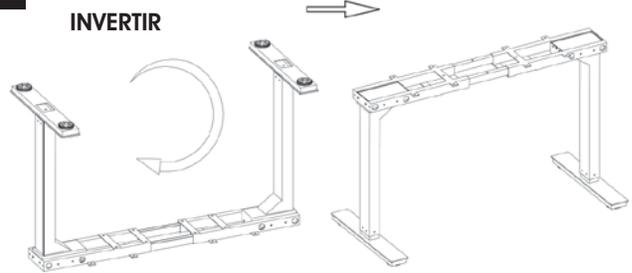
**5** Fije las patas y las bases de las patas con tornillos M6 como se muestra.
