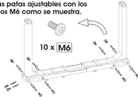
**3** Unir las patas y las bases de las patas con tornillos M6 como se muestra
