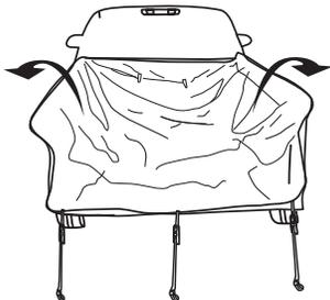
3. Attacher les petites crochets trouvés à l'avant coins de la planche de la tente à les crochets sur le lit du camion près de la cabine du camion.
