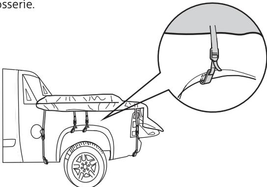
5. Repérer les sangles de la tente qui s'attache au hayon (3 sangles). Glisser les 3 sangles (élément mâle) entre le hayon et la caisse de la camionnette. Attacher les sangles (élément mâle à l'élément femelle).
