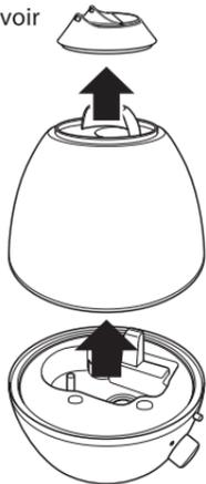
2. Retournez le réservoir d'eau et tournez le bouchon du filtre dans le sens anti horaire.
