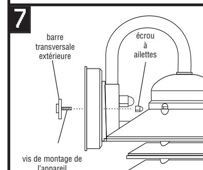
Placer l'appareil sur les vis de montage de l'appareil et s'assurer que l'ensemble est proprement fixé avec les écrous à ailettes fournis.
