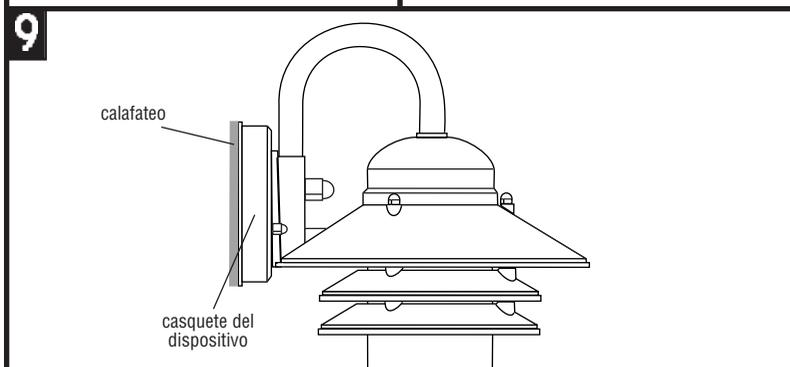
NOTA: El dispositivo tiene que calafatearse con calafateo (caulk) acrílico donde la base del dispositivo toca la superficie (el techo ó la pared) en que se montó. Elcalafateo crea un sello impermeable en ellugar de instalación.
