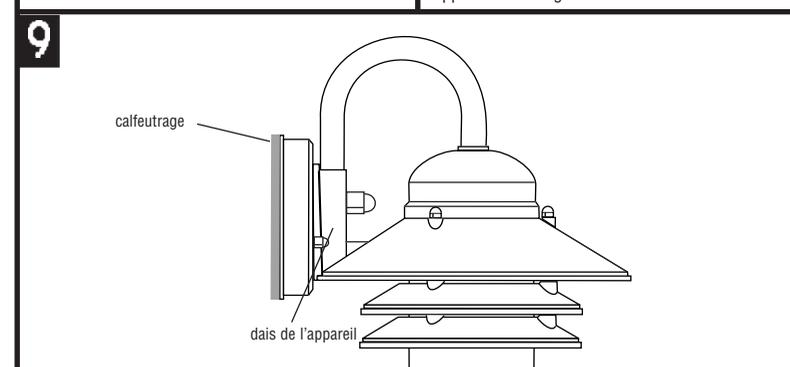
NOTE: L'appareil DOIT être calfeutré avec un calfeutrage acrylique là où l'appareil est en contact avec la surface de montage. ceci fournit un joint étanche lorsque l'appareil est installé.
