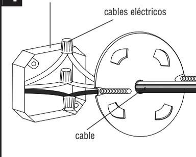
CONNECTAR LOS CABLES. NOTA: Unir cable negro del dispositivo al cable negro de la toma eléctrica, el cable blanco del dispositivo al cable blanco de la toma eléctrica. No los mezcle. Usar conectadores de cables eléctricos (no incluidos).
