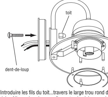
Introduire les fils du toit...travers le large trou rond du dais. Alinear les deux renflements du dais avec les renflements du toit et insérer le dais dans le toit. S'assurer que le dais est bien au même niveau que le toit. Insérer le dent-de-loup dans l'ouverture carrée au dos du dais et fixer le toit au dais avec l'écrou en forme de gland.
