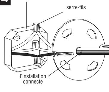
RACCORDER LES FILS. NOTE: attacher le fil noir de l'appareil au fil noir d'alimentation et le fil blanc de l'appareil au fil blanc d'alimentation. Ne pas les mélanger. Utiliser des serre-fils (non fournis).
