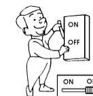
Ensuite - aller à la boîte de fusibles principale. Si votre boîte de fusibles est pourvu d'un interrupteur ON/OFF simplement placer l'interrupteur d'alimentation principale en position OFF.
