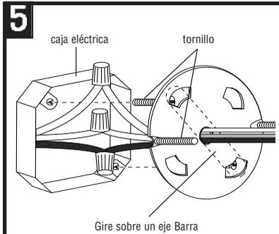
Incluya girar sobre un eje - prohíba a caja-enchuf e con dos 8-32" tornillos (no proveída). Inserten tornillos a trav és de apertura rectangular y en girar sobre un eje barra. Aprieten tornillos.
