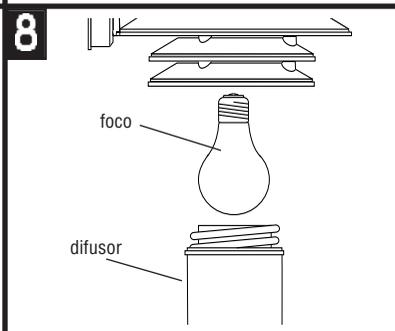
Instalar el foco en el casquillo. Asegurarse de usar un foco de una potencia de vatios no más alta que lo especificado para esta artefacto. Enroscar el difusor a la cubierta.
