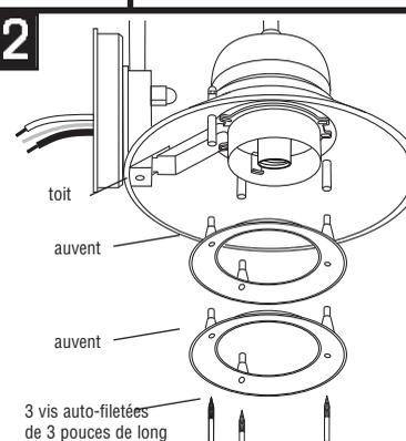
Aligner les bornes au-dessus d'un auvent et insérer dans les trous au-dessous de l'autre auvent. Aligner les bornes sur l'auvent du haut avec les renflements du toit et fixer la vis auto-filetée de 3 pouces de long.
