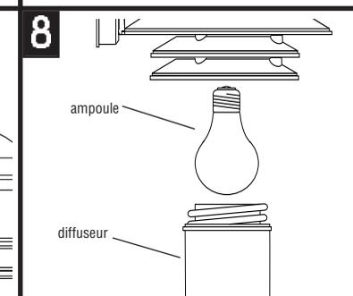
Installer l'ampoule dans la douille. S'assurer de Ne Pas Excéder la puissance en watts pour votre appareil d'éclairage. Visser le diffuseur dans le toit.
