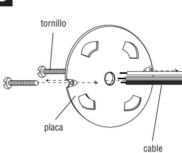
El hilo una pulgada cu largos tornillos en placa montadora y alimentan alambres de cierre a través del agujero en el centro de la placa montadora.
