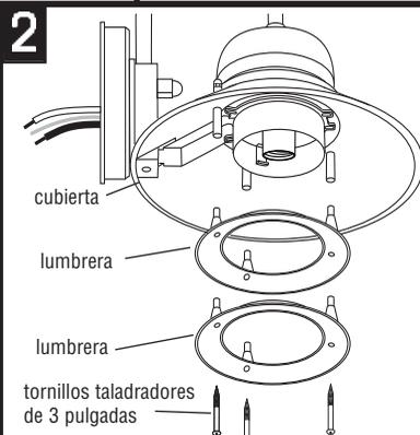
Alinear los poste encima de las lumbreras e insertar en los agujeros debajo de las otras lumbreras. Alinear los poste en la lumbrera de encima con las protuberancias de la cubierta y asegurar con los tornillos taladradores de 3 pulgadas.
