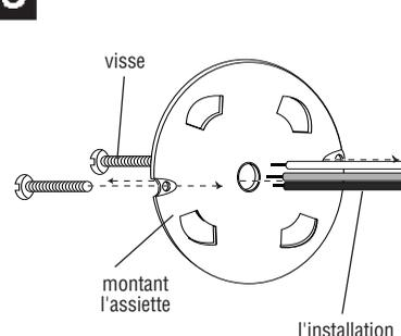
Le fil on avance des vis longs en monter des fils d'installation d'alimenter et assiette par le trou dans le centre de l'assiette l'assiette monter.
