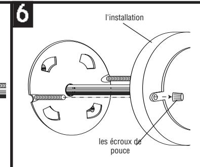
L'installation de position sur l'installation montant des vis et vis sur avec des écrou de pouce.
