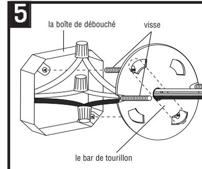
Attacher le bar de tourillon à boîte de débouché avec deux 8-32 vis (ne fournissait pas). Ces vis devraient être insérés par l'ouverture rectangulaire appropriée dans l'assiette et en le bar de tourillon. Serrer des vis.
