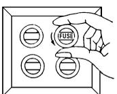
Dans le cas des fusibles pouvant être vissés, dévissier le ou les fusibles qui contrôle (nt) l'alimentation à l'appareil d'éclairage ou à la pièce dans laquelle l'installation a lieu.
