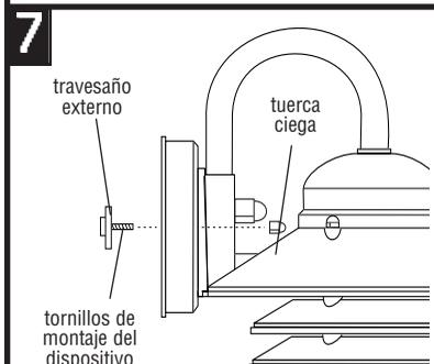
Colocar el dispositivo sobre los tornillos de de montaje del dispositivo y saegurar en posición con las tuercas ciegas incluidas.
