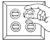
Fusibles desatornillables. Desatornille los fusibles que controlan la electricidad en el cuarto que va a trabajar.
