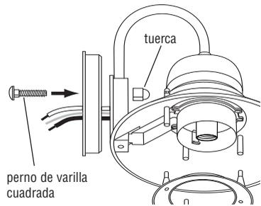
Pasar los cordones eléctricos de la cubierta a través del agujero grande en el casquete. Alinear las protuberancias en el casquete con las protuberancias en la cubierta e insertar casquete en la cubierta. Asegurarse que el casquete quede parejo a la cubierta. Insertar perno de varilla cuadrada en la abertura cuadrada detrás del casquete y asegure con la tuerca.
