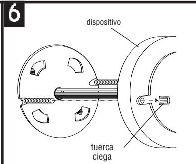
Coloque cierre sobre tornillos montadores y seguros con nueces de pulgar proveídas.
