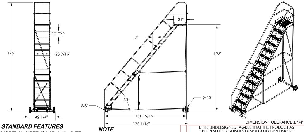
MODEL NUMBER IS LAD-14-21-P-EZ OVERALL WIDTH IS 42 1/4" USABLE WIDTH IS 23 9/16" OVERALL LENGTH IS 135 1/16" USABLE LENGTH IS 131 15/16" **OVERALL HEIGHT IS 176" TOP STEP HEIGHT IS 140"** STEP TYPE IS PERFORATED CLIMB ANGLE IS 50° STEP DEPTH IS 7" TOP STEP DEPTH IS 21" MAX CAPACITY IS 350 LBS WHEEL SIZE IS Ø10" FRONT WHEEL SIZE IS Ø 3" TOUGH BAKED IN POWDER COATED BLUE FINISH BOTTOM STEP HAS TOUGH BAKED IN POWDER COATED YELLOW FINISH
