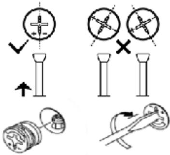
Avant de raccorder les excentriques, bien s'assurer que la position de départ est correcte avant d'insérer le boulon de connection.
