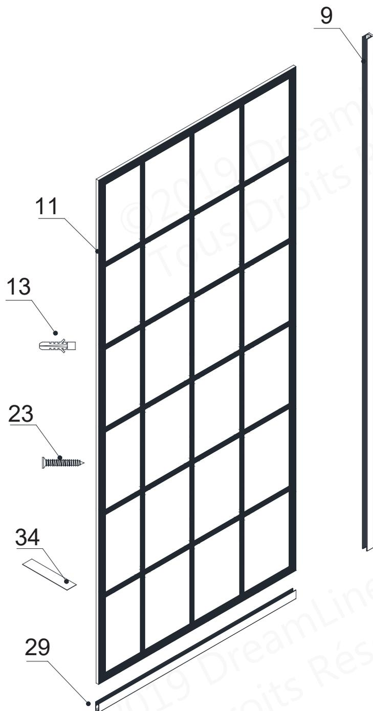
La surface texturée de la porte vitrée doit se trouver du côté extérieur de la douche.
