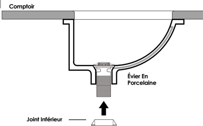
De dessous le comptoir, insérer le joint inférieur sur la zone filetée du drain.
