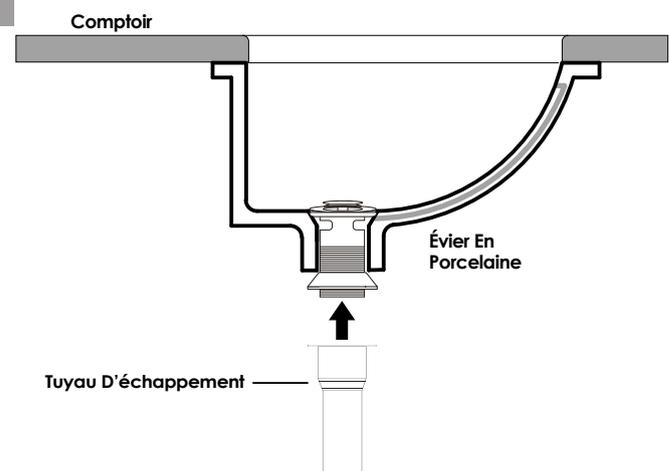
Fixez le tuyau d'échappement, il est recommandé d'ajouter du téflon aux filetages du tuyau, ce tuyau d'échappement s'adapte à la tuyauterie de plomberie domestique de 1-1 / 4 pouce.
