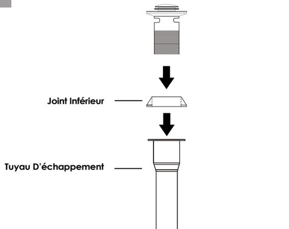
Retirez le joint inférieur et le tuyau d'échappement de l'enveloppe filetée.
