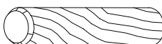
9 WOOD DOWEL/ SERVIETTE EN BOIS/ CLAVIJA DE MADERA x 19 (Ø8 X 30MM)
