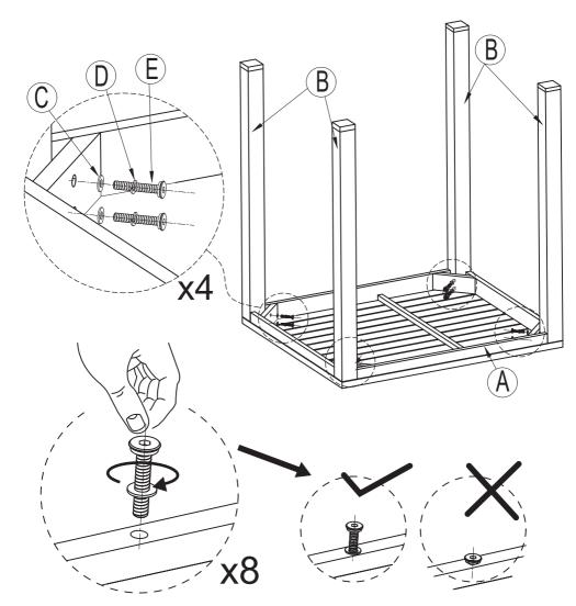
NOTE: DO NOT TIGHTEN THE SCREWS COMPLETELY.
