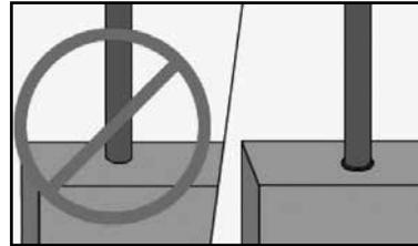
**Paso 3:** Usando un taladro, atornille los conectores de balaustre Deckorators (se venden por separado) en cada marca, usando los tornillos provistos. Aplique masilla de silicona en cada conector para evitar que los balaustres se muevan una vez finalizada la instalación. La masilla debe estar por fuera del conector, en donde el balaustre estará en contacto con el borde exterior del conector.
