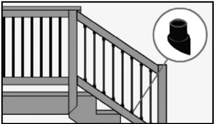
**Paso 7:** La instalación de barandales y balaustres de escalera puede representar un desafío. Los conectores para barandal de escalera en ángulo Deckorators (se venden por separado) crean un ajuste preciso para balaustres en escaleras con ángulo de 35 grados. Corte los barandales superior e inferior de la escalera al ángulo apropiado. Coloque los barandales superior e inferior de 2x4 a lo largo de los postes y márquelos.
