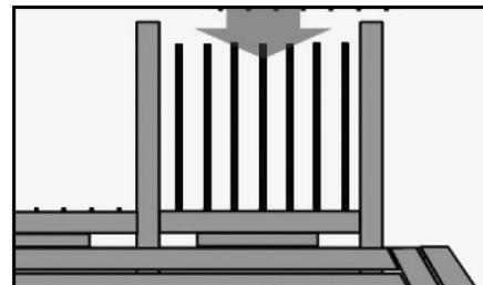
**Paso 4:** Coloque el barandal inferior entre los postes, sostenido con un bloque de 7.6 cm (3 pulg.) (los residuos de material de 2x4 funcionan mejor). Sujete el barandal a los postes usando conectores para barandal Deckorators (se venden por separado) y deslice los balaustres sobre los conectores inferiores. Coloque cuidadosamente el barandal superior sobre los balaustres, asegurándose de que cada balaustre quede bien asentado sobre cada conector.
