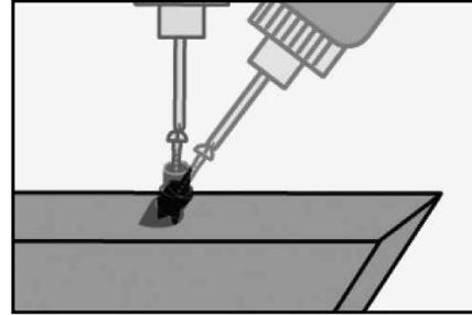
**Paso 9:** Coloque correctamente los conectores en los barandales. Los conectores superiores e inferiores estarán colocados en direcciones opuestas. Atornille los conectores en sus sitios. Para fijar los conectores en ángulo correctamente, comience a atornillar verticalmente hasta que el tornillo entre en la madera. Vuelva a posicionar el tornillo al ángulo correcto y apriételo. No apriete demasiado, pues podría desplazar el conector del centro.
