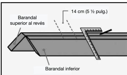
**Paso 8:** Una con abrazaderas los barandales superior e inferior, con el barandal superior de 2x4 invertido. Coloque los barandales como se muestra y marque 14 cm (5-1/2 pulg) de centro a centro, trabajando desde el centro hasta los extremos de los barandales.
