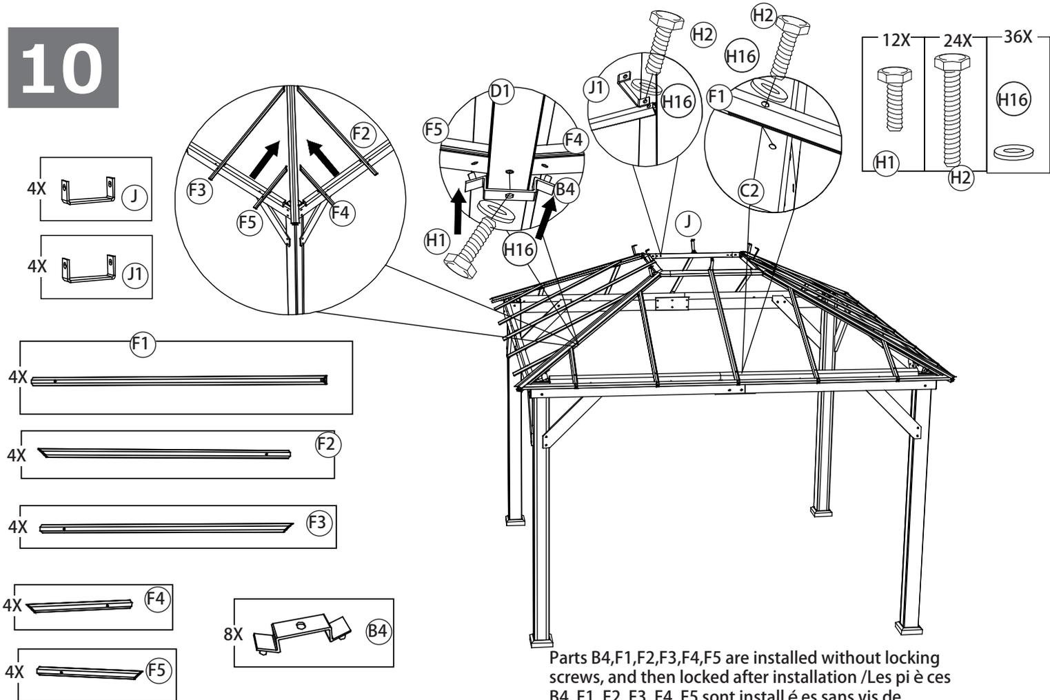
Parts B4,F1,F2,F3,F4,F5 are installed without locking screws, and then locked after installation /Les pi è ces B4, F1, F2, F3, F4, F5 sont install é es sans vis de verrouillage, puis verrouill é es apr è s l'installation
